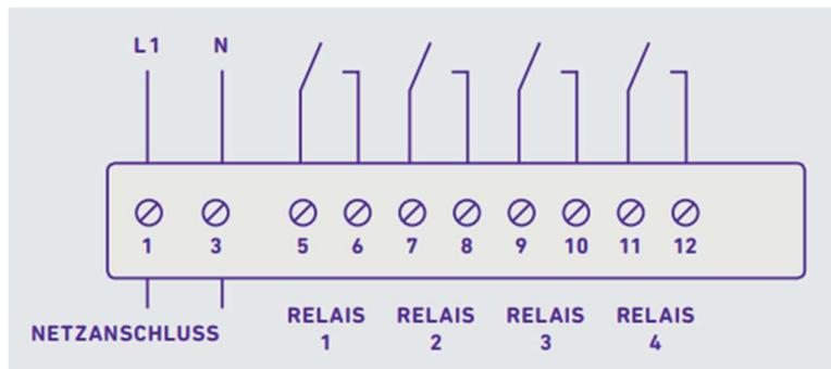
Betriebsspannung: 230 V<sub>AC</sub>
