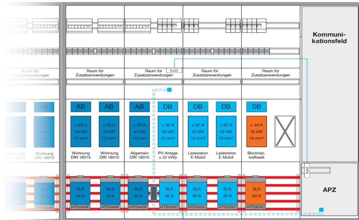
Beispiele von Zählerplätzen mit Funktionsflächen nach DIN 43870 mit integrierter Befestigungs- und Kontaktiereinrichtung (BKE-I nach DIN VDE 0603-5) sowie nach DIN 43870 für Zähler mit Dreipunkt-Befestigung:
