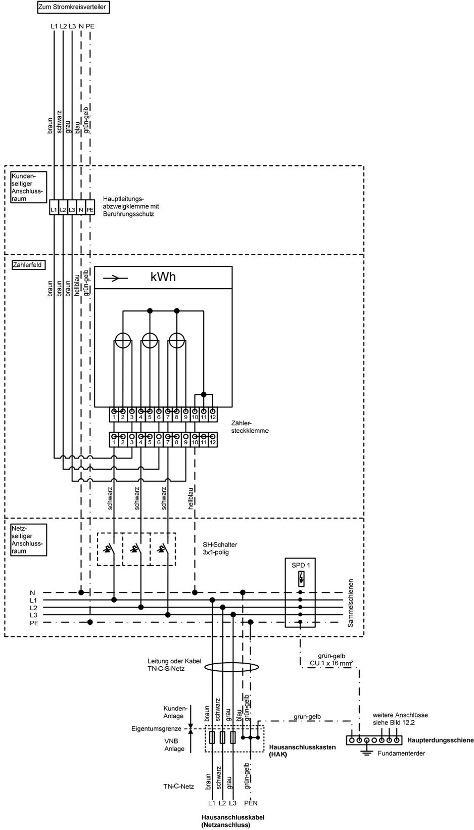
Bild 5.2 Anschlusschema Freileitungshausanschluss
